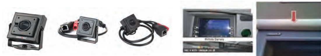
شکل ۱۴- دوربین سوزنی
