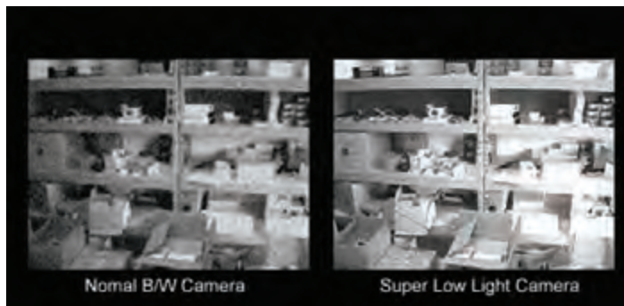
شکل ۱۸- تأثیر مشخصه Minimum Illumination در تصویر
