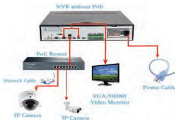
شکل ۱۷- اتصال دوربین به NVR
