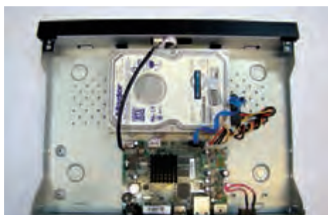
شکل ۳۵- محکم کردن دیسک سخت در محل نصب
