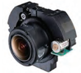
شکل ۷- لنز Motorized
