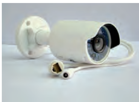
شکل ۱- اجزای دوربین تحت شبکه
