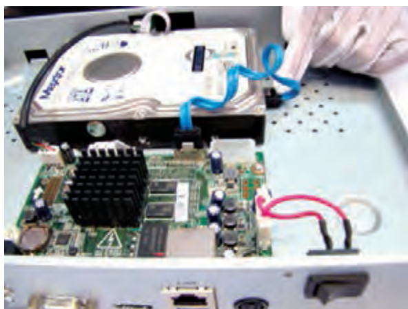
شکل ۳۳- اتصال کابل داده دیسک سخت
