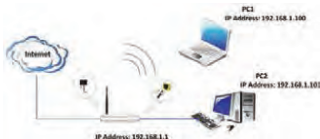
شکل ۳- شبکه خانگی مودم ADSL
