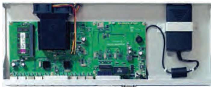
شکل ۴- نمای داخلی مسیریاب میکروتیک
